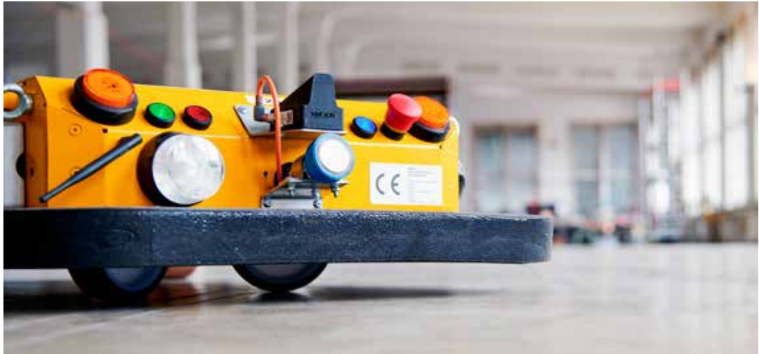
Intelligente Navigation für fahrerlose Fahrzeuge: Kinexon Brain mit sensorbasierter Ortung implementiert in einem IoT-Gateway.
