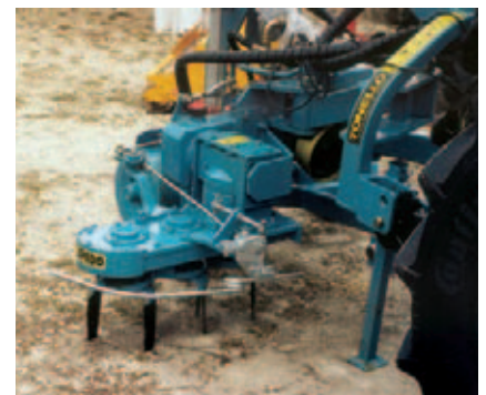
Fresa con erpice rotante e dispositivo scansacceppi.
