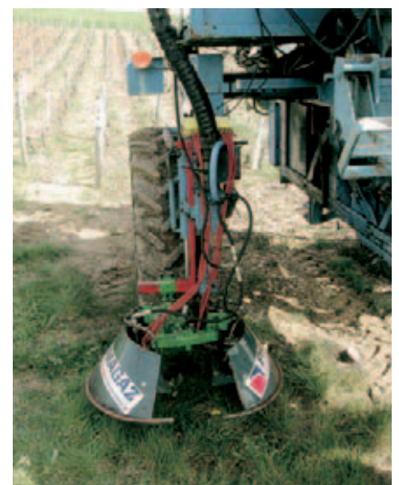
c) Apparecchio per il diserbo termico a gas liquido.
