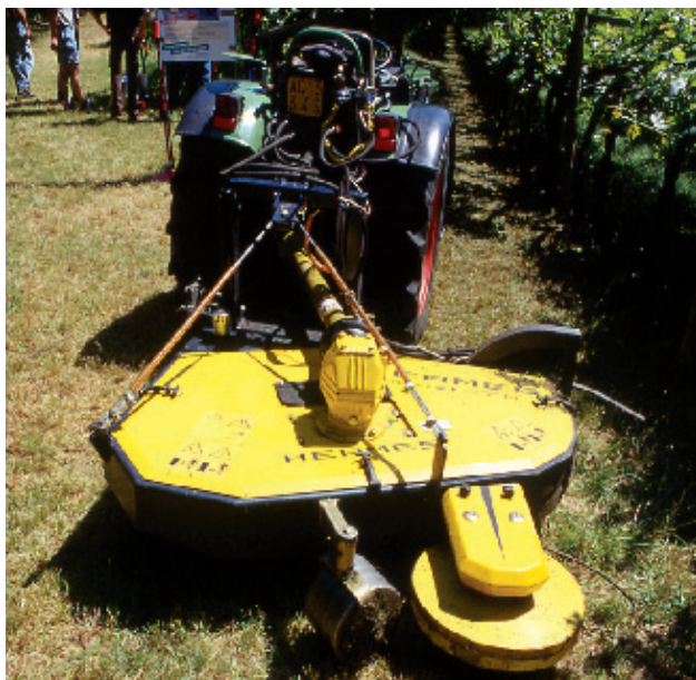
Trinciaerba a coltelli con dispositivo di rientro lungo la fila.
