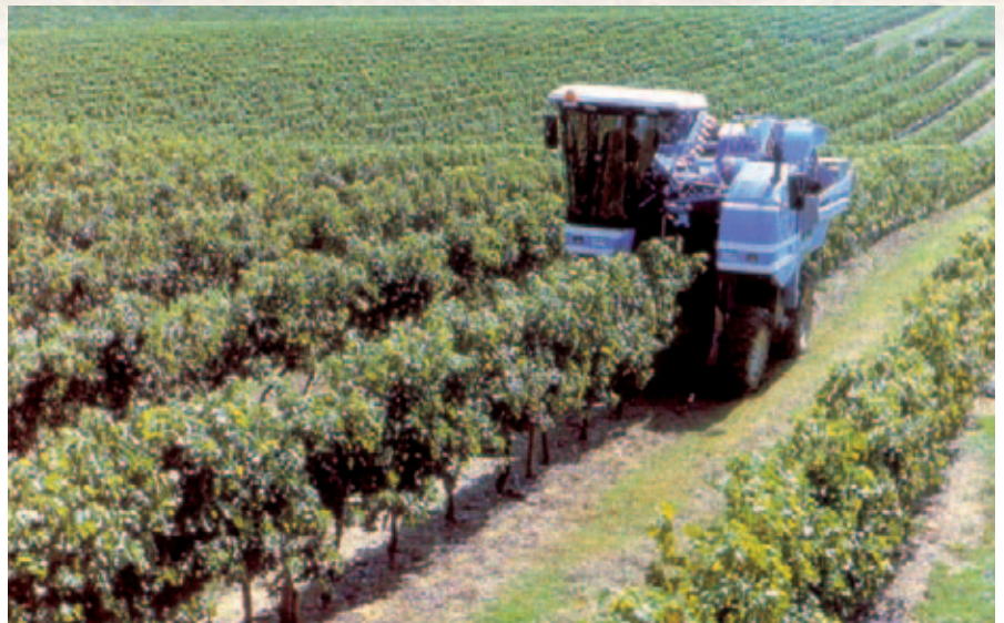
Vendemmiatrice in azione in terreno inerbito. L'inerbimento consente l'impiego di mezzi pesanti come le vendemmiatrici.
