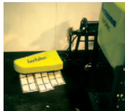
Barra da diserbo con dispositivo umettante.
