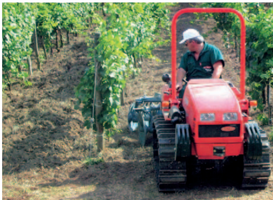
Erpice a dischi in azione nell'interfilare.
