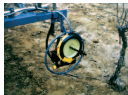
Dispositivo per la distribuzione micronizzata a bassissimo volume.
