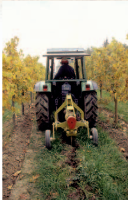
Aratro talpa in azione di decompattamento e drenaggio.
