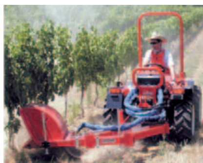
b) Diserbatrice meccanica con dispositivo spollonante.
