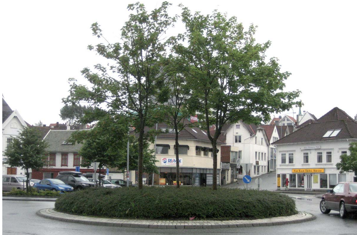
Platanlønn og mispel dekker godt i rundkjøring. Plantene brukes ikke lenger i veganlegg for henholdsvis spredningsfare (platanlønn) og vertsplante for pærebrann (mispel).
