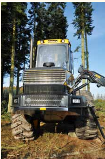
Forvognen på Bear 6WD nivelleres konstant under kørsel så den altid står vandret.
