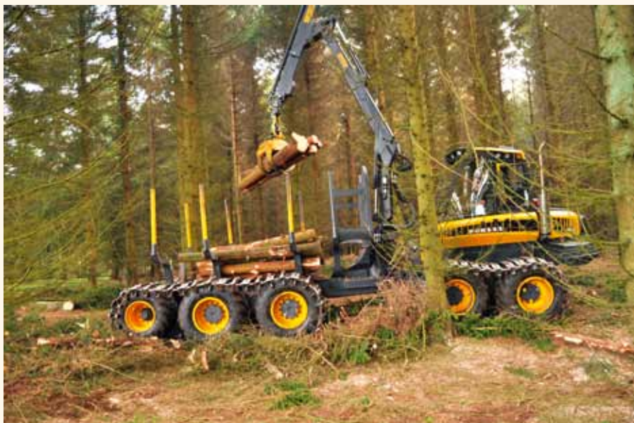
Ponsse Wisent 10WD med 10 hjul til skånsom kørsel på blødbund.
