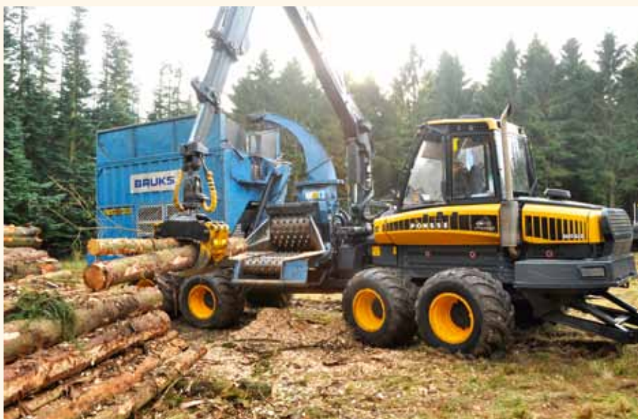
Ponsse Buffalo 8WD med Bruks 805.2 flishugger til flishugning af grene og toppe eller som her afkortet træ.
