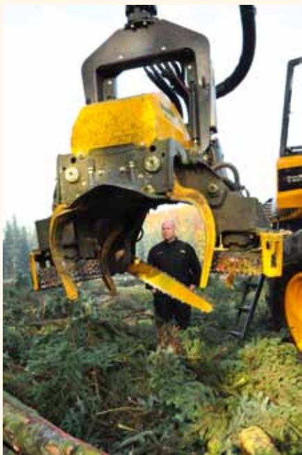
Ponsse H8 aggregatet klarer træer op til 72 cm i rodsnittet.
