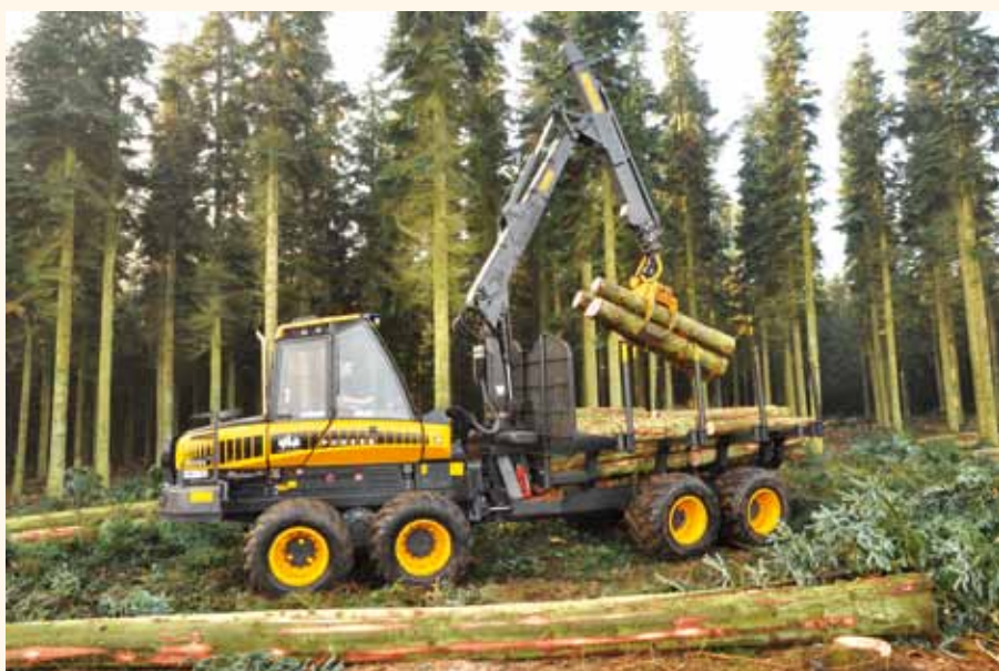
Lastrummet i Ponsse Buffalo kan reguleres i længden og rummer her to stykker afkortet tømmer.
