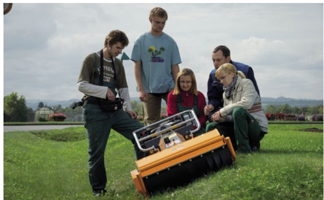
Übungen mit einem ferngesteuerten Böschungsmäher
