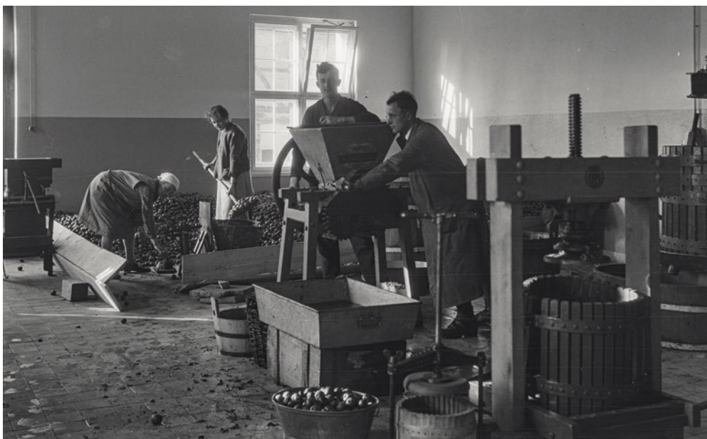
Mahlen und Pressen von Äpfeln zur Süßmostherstellung in den Räumen der Abteilung Obst- und Gemüseverwertung im ehemaligen Hofwaschhaus
