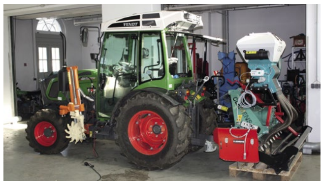
Schmalspurtraktor der Überbetrieblichen Ausbildungsstätte mit Rollhacke und Sämaschine für die Winzerlehrgänge
