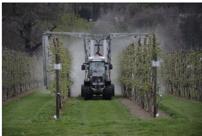
Modernes Sprühgerät mit Recyclingtechnik zur Abdriftminimierung bei der Ausbringung von Pflanzenschutzmitteln
