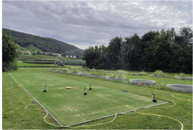
Versuche zur Regenwasserversickerung auf Sportplätzen mit Kunstrasen
