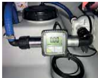
Zähler FMT 3 mit Impulsausgang
