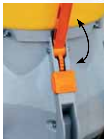
Streumenge einstellbar mit festem Anschlag
