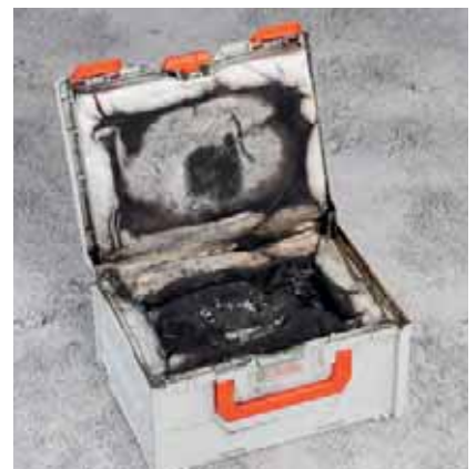
Erfolgreicher Brandversuch: die CEMO Brandschutzbox hält.
