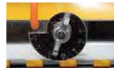
robuste Rührwelle, Achse mittig geteilt, einstellbare Rührflügel
