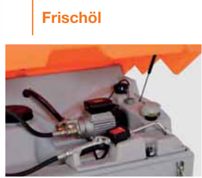
Frischöl Elektrozahnpumpe 230 V, 9l/min, 12 bar und digitaler Handdurchlaufzähler für Schmierstoffe (nicht eichfähig*)
