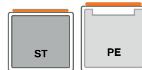
DT-Mobil PRO Außenbehälter aus Stahl, Innenbehälter aus Stahl oder PE
