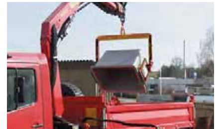
Auskippen des Streugutes auf die LKW-Pritsche (Beispiel mit Streugutbehälter 700l)
