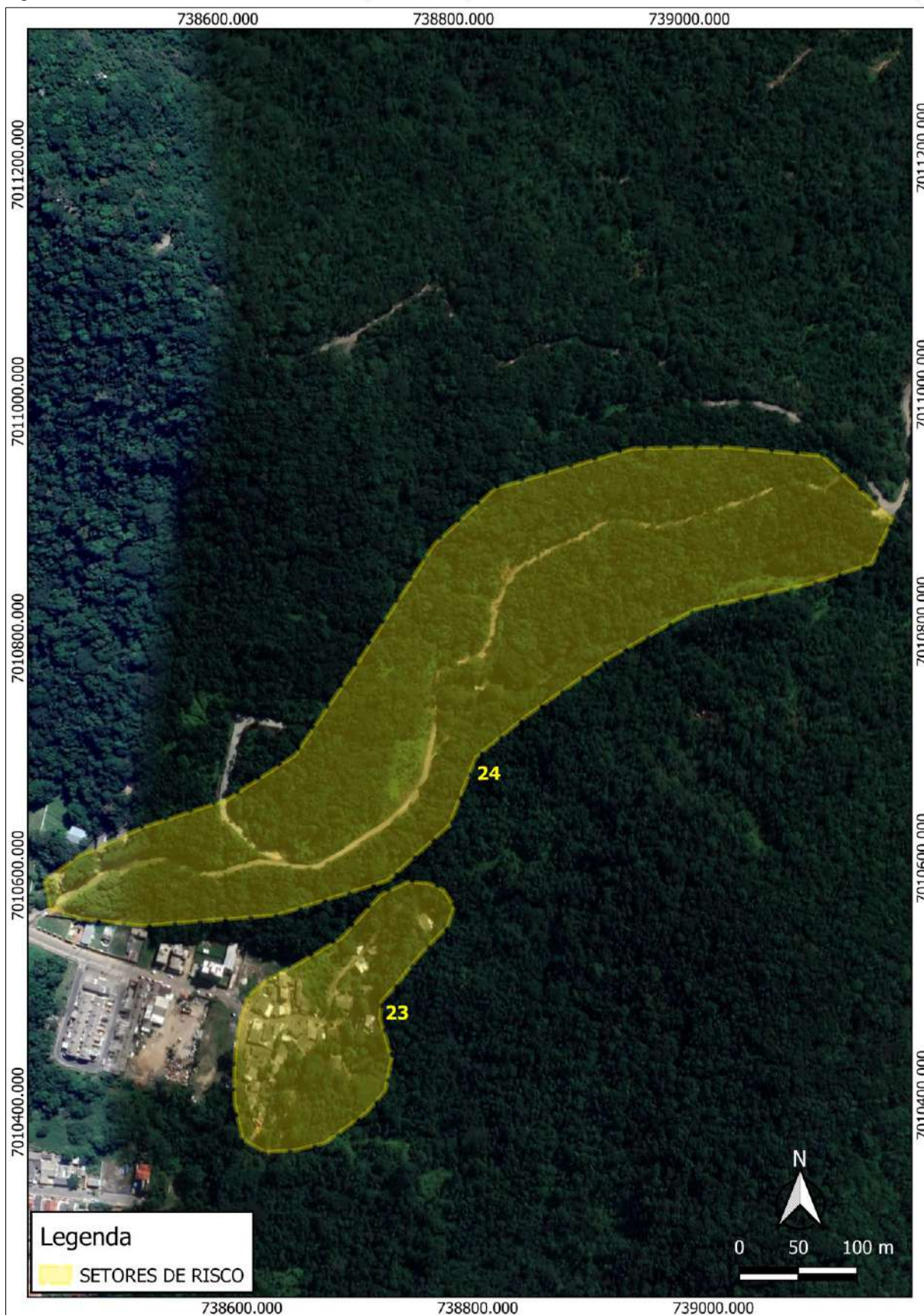
Figura 49 - Movimentos de Massa: Setor de Risco 24.
