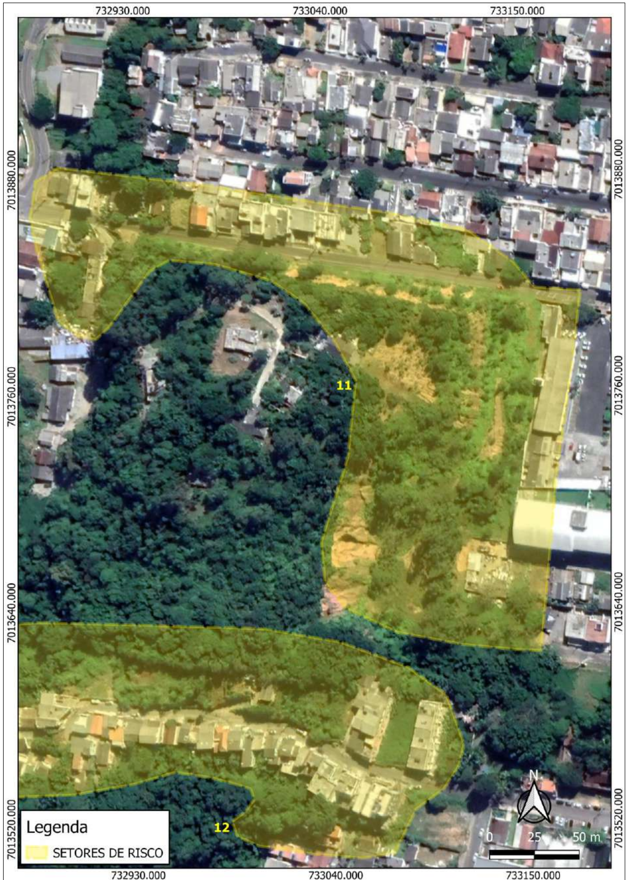
Figura 36 - Movimentos de Massa: Setor de Risco 11.
