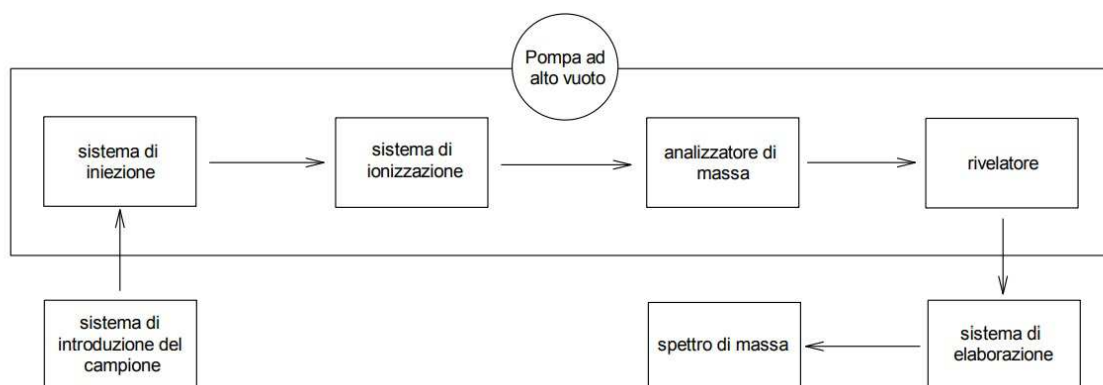
Figura 34: Schema dello spettrometro di massa.
