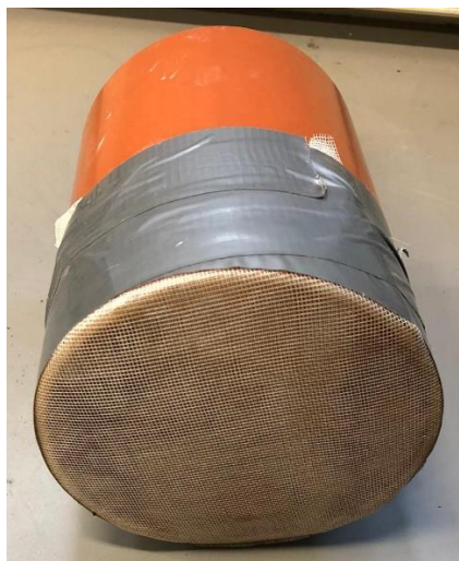
Abbildung 18: selbstgebautes Sieb Quelle: © Universität für Bodenkultur, Wien, Oliver Weiss
