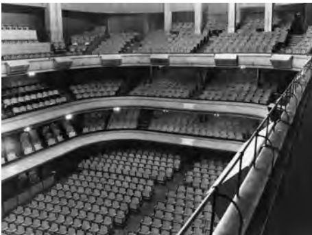
Fig. 1.45: Concert hall of the Gebouw voor Kunsten en Wetenschappen. Loudspeakers of the reverberation system are visible along the upper balcony.
