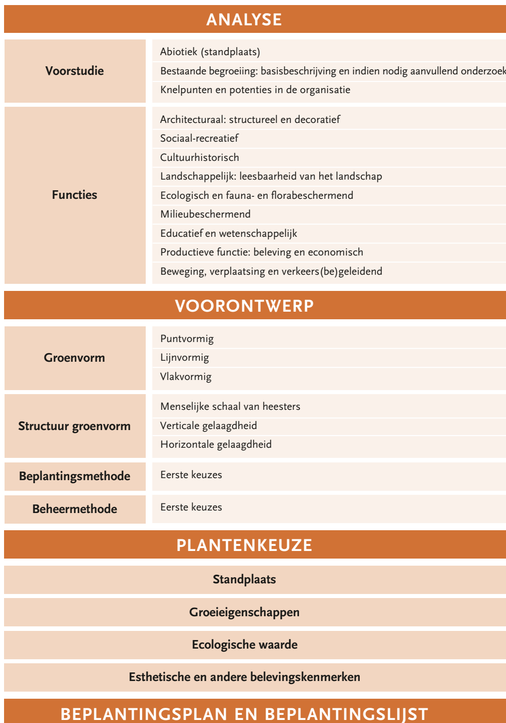
Figuur II.1 – Doorstroomschema voor de opmaak van het beplantingsontwerp. Deze benadering is gebaseerd op Alexander, Ishikawa & Silverstein (1977); Reuver (2001).
