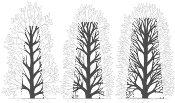
Figuur IV.9 – Tijdens het ontwikkelingsbeheer wordt de geschoren haag laag voor laag opgebouwd en wordt de onderzijde van de haag breder gehouden dan de bovenzijde (Reuver, 2001).
