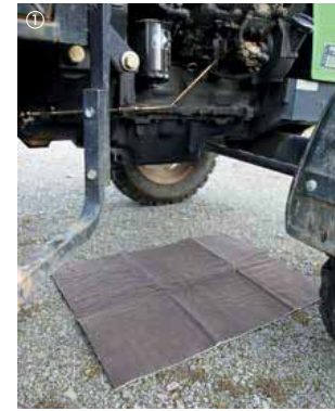
Anwendung des Ölsaugteppichs aus dem Cemsorb-Notfallset Agrar
