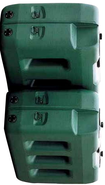
Großspeicher mit großem Revisionsdom, 2 Anschlüssen 2" und 2 Flanschsanschlüssen (2000 und 3000 l)
