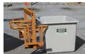
Einfahren des Ladebügels von der Seite nach dem Entfernen des abnehmbaren Deckels (Beispiel mit Streugutbehälter 700l)
