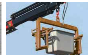
Anheben des Behälters (Beispiel mit Streugutbehälter 200l)
