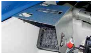
CUBE-Tank für AdBlue®, Heizung mit Thermostat
