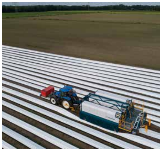
Le robot détecte le turion, gorgé d'eau, grâce à un champ électrique.
