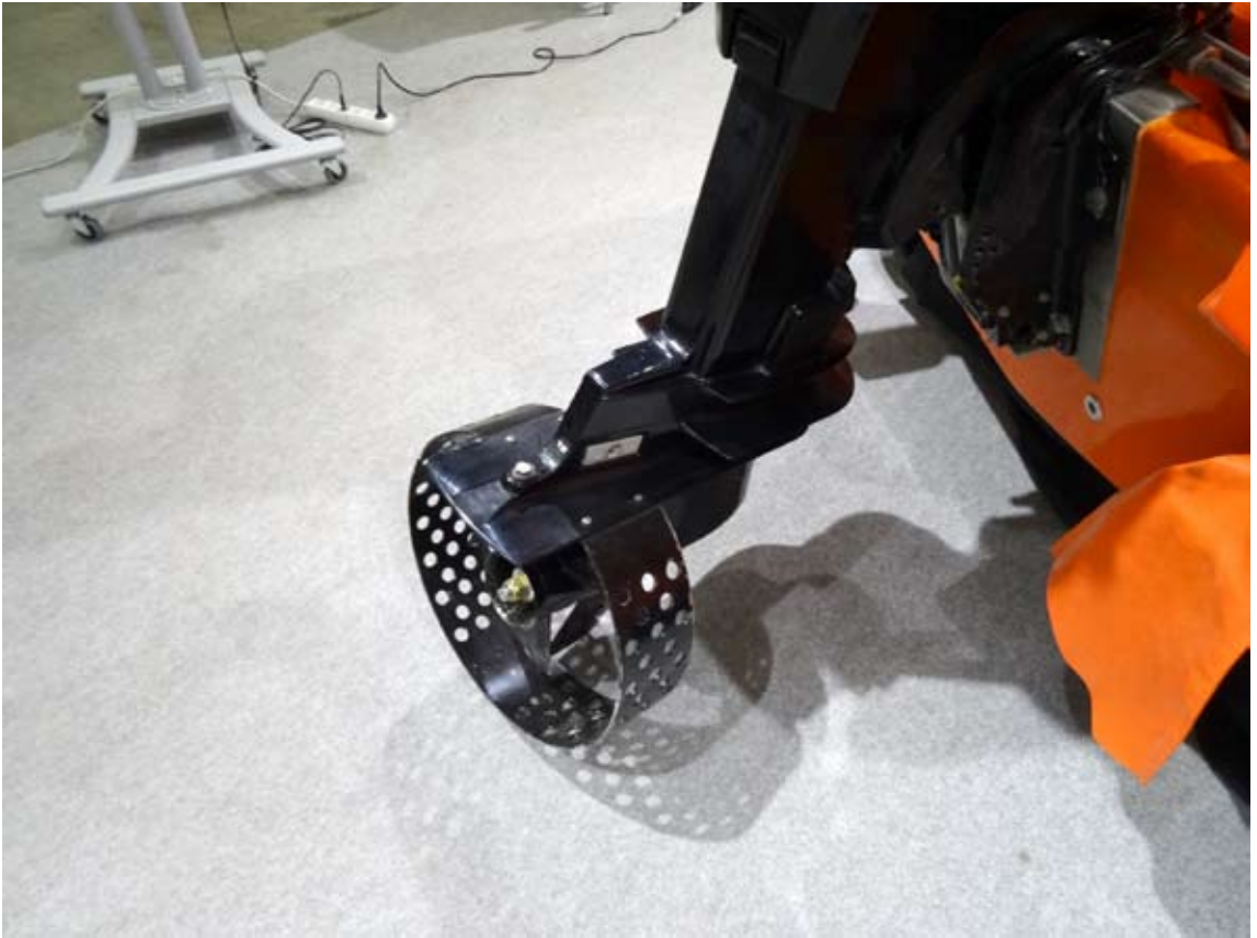
Perämeren oloihin suojattu perämoottori
