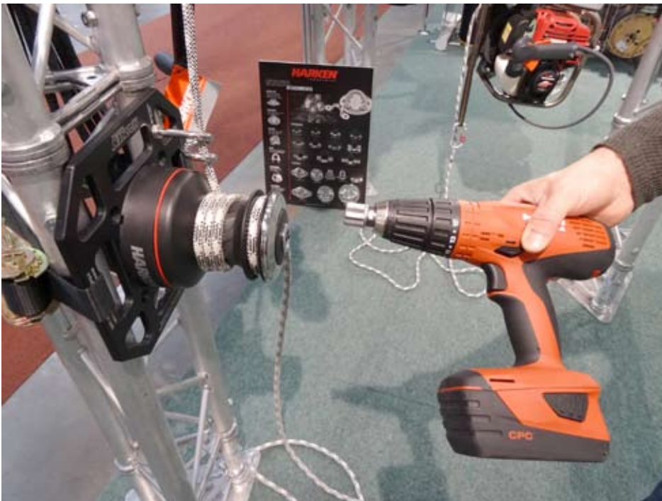
Kuva 4. porakoneen sovitusaosa vinnikäyttöön?!
