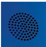
Der doppelte Boden dient der Abtrennung fester Teile von flüssigen.
