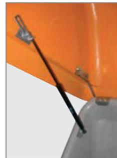
Gasdruckfedern für leichtes Öffnen
