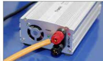
Kabelanschluss direkt am Netzgerät 230V (Varianten 10590, 10591, 10592)
