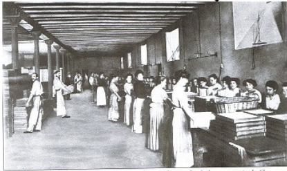
La technique de l'enflourage, aujourd'hui tombée en désuétude, fit la renommée de Grasse au XVIII e siècle. Ce procédé consistait à recouvrir d'un mélange de graisse de porc et de bœuf des plaques de verre de 50 à 60 cm de côté insérées dans des cales en bois, le tout constituant des châssis. 30 à 50g de fleurs fraîches étaient délicatement posés sur la graisse. On empaquetait alors ces châssis sur des tables par piles de 34. L'opération était renouvelée 30 ou 40 fois, jusqu'à saturation de la graisse qui était ensuite recueillie puis traitée. Ce procédé exigeait un nombre impressionnant de châssis - 80 000 dans les établissements Chiris.
